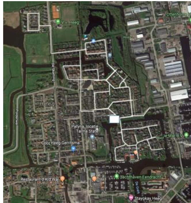
Figuur 23: Warmtenet achter Unit 1
